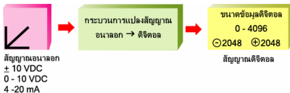
รูปที่ 1.18 ไดอะแกรมการส่งข้อมูลอนาลอกให้ PLC
